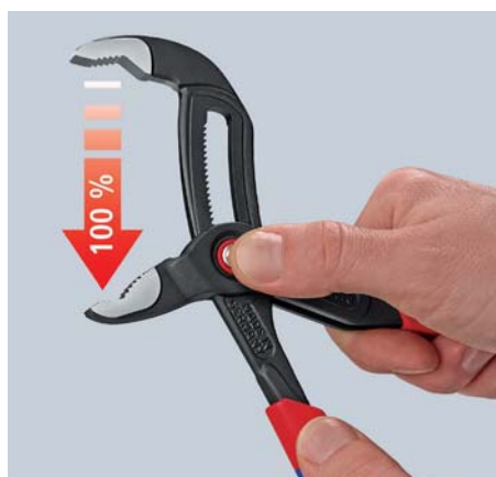
Stisknout knoflík – kompletně otevřít kleště
