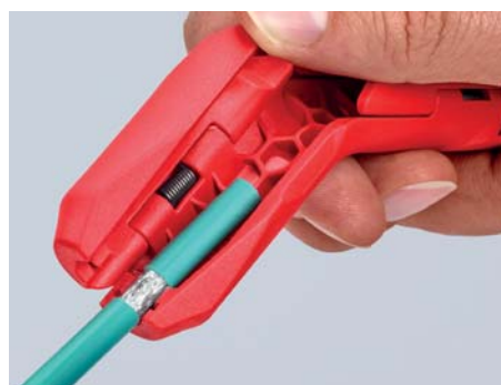
Odizolování datového kabelu
