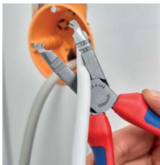
Řezání kabelu do Ø 13 mm
