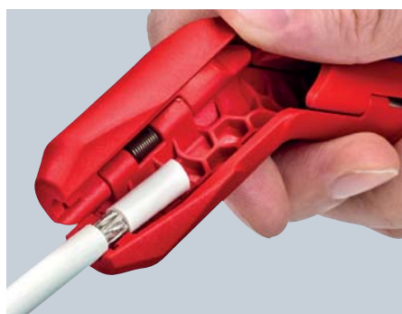
Odizolování koaxiálního kabelu
