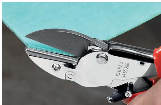
Snadné střihání desek lehké konstrukce
